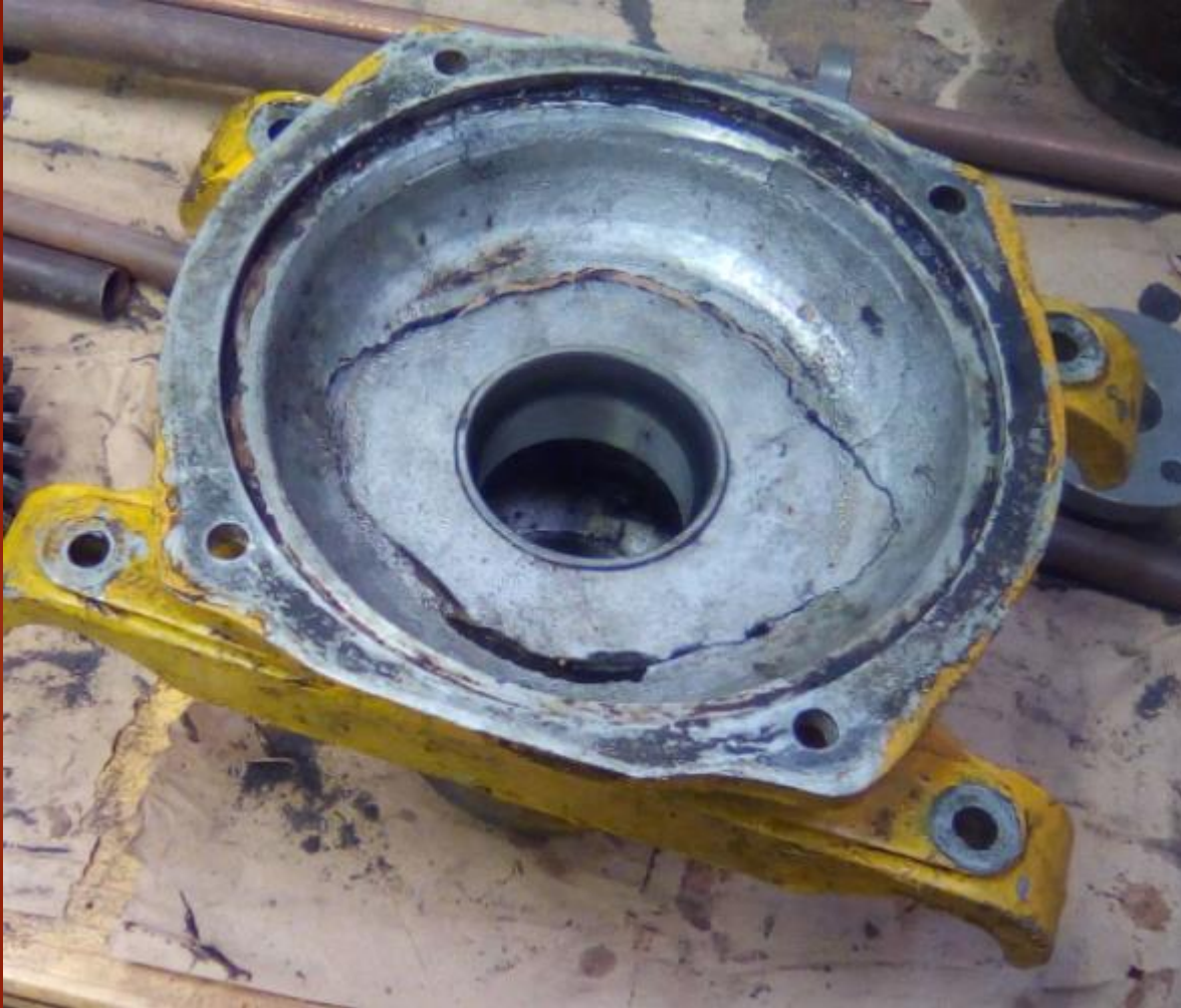
Pièce cassée avant soudure
