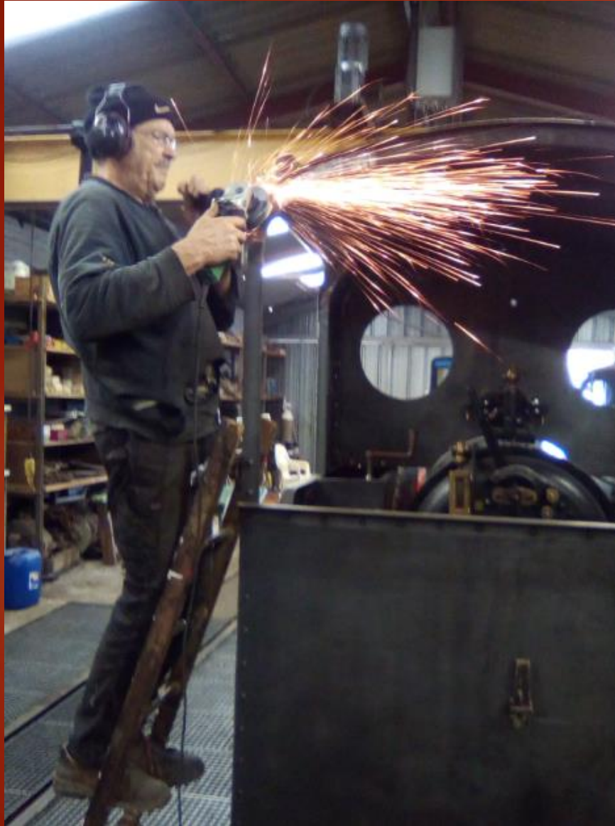
Finition toiture et découpe des vis tête ronde
