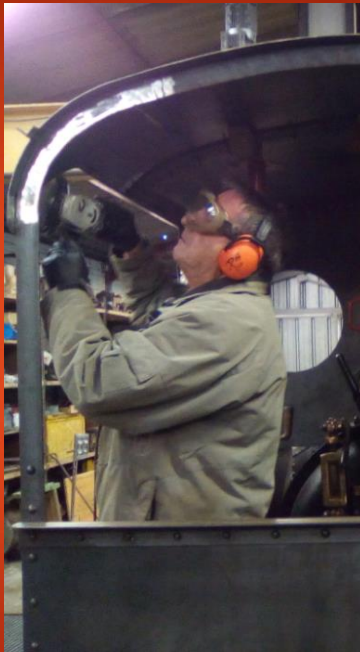
Finition toiture et découpe des vis tête ronde
