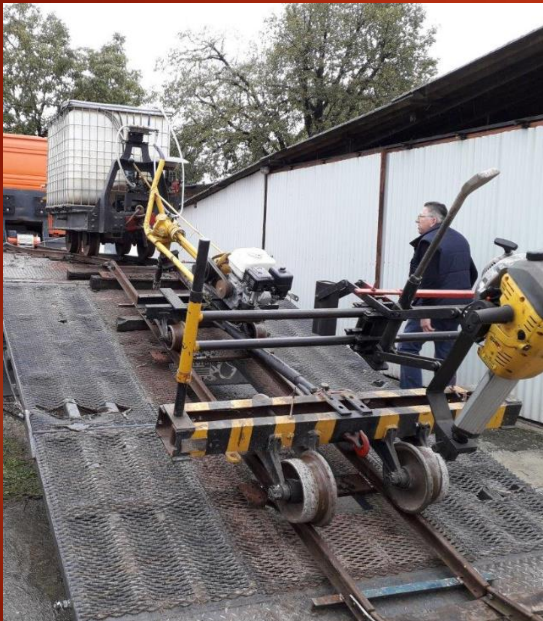
La montée: désherbeur , tirefonneuse et bourreuse
