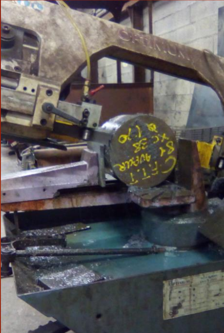
Découpe de la plaque de caisse à eau manquante et mise en place
