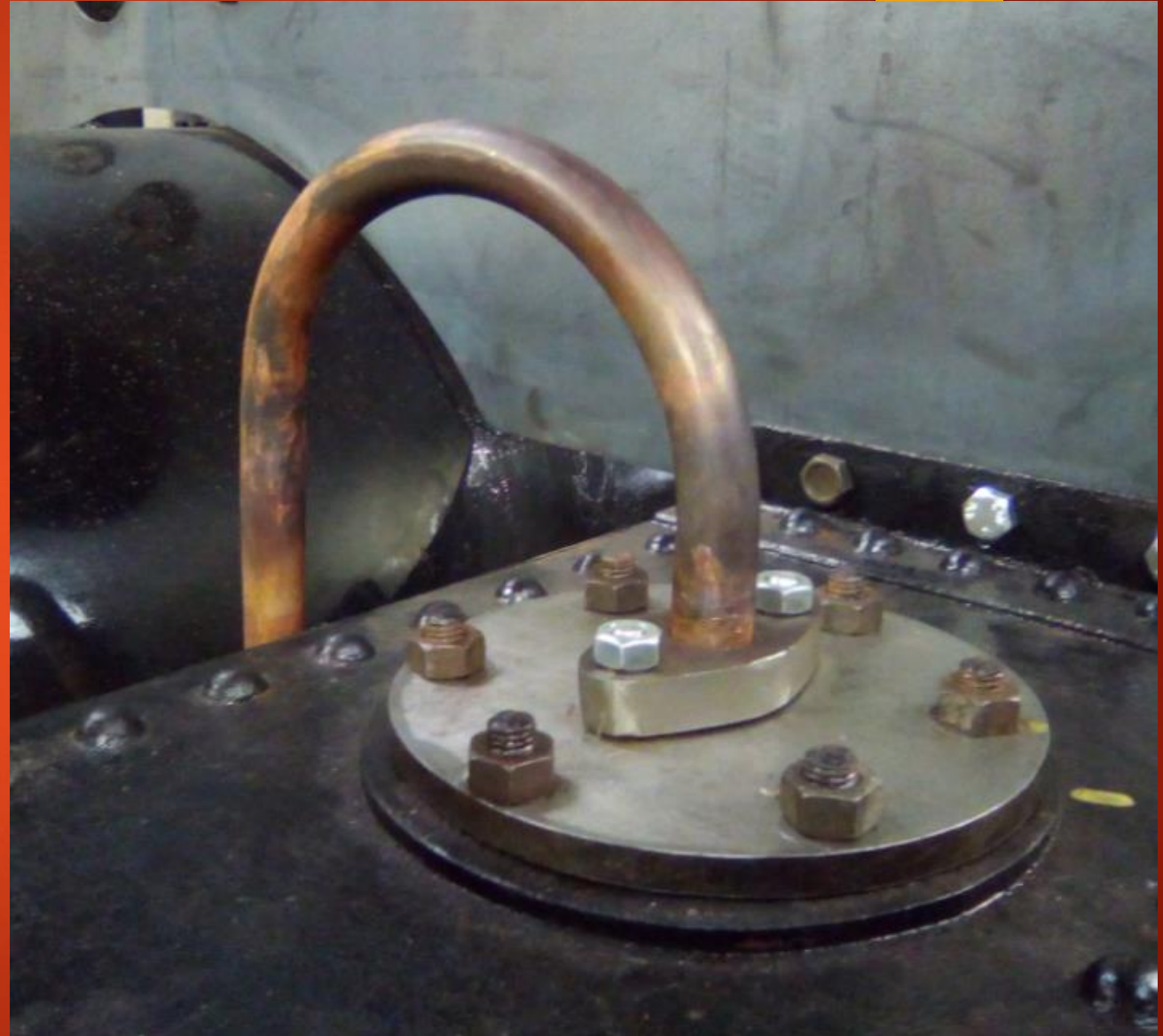
Découpe de la plaque de caisse à eau manquante et mise en place
