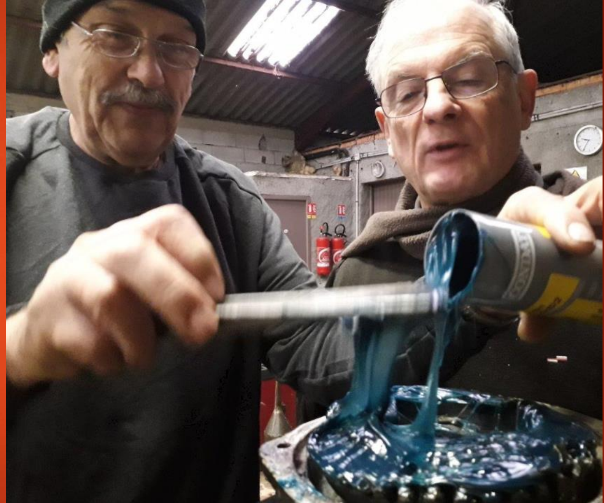
Graissage après réparation et remontage à la presse
